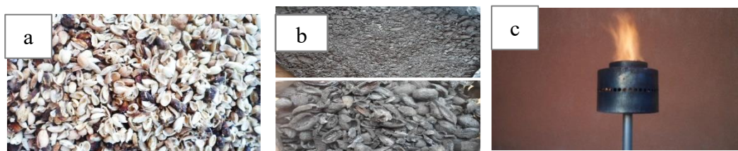
Figure III.11: (a) échantillon de coque de Balanites aegyptiaca , (b) cendre et charbon résiduel (imbrulés) après gazéification ; (c) flammes produites lors du test
