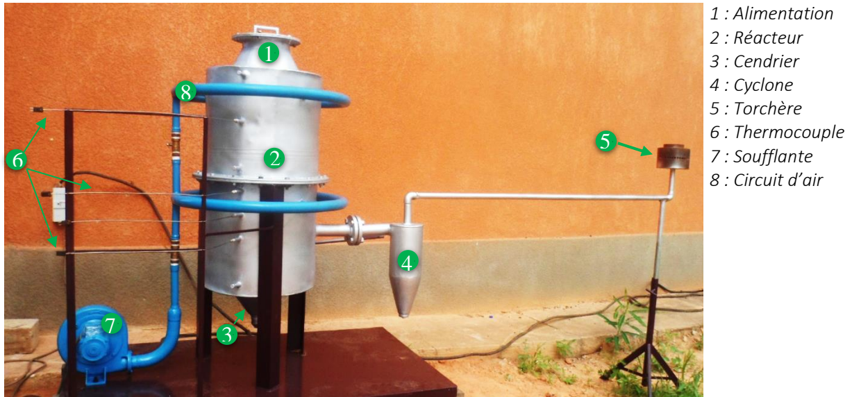
Figure II .1: Gazogène de l'étude (Gado et al, 2019)
