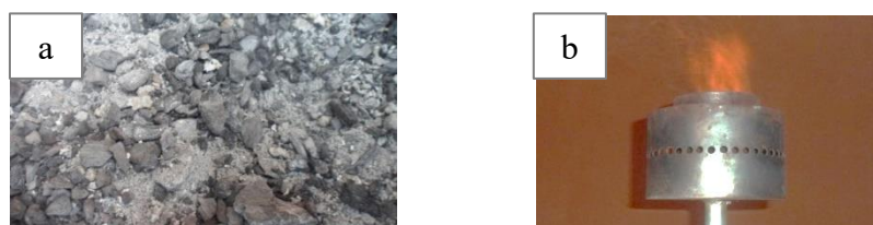
Figure III.13: (a) résidus de cendre du charbon de bois après gazéification, (b) flamme produite lors de l'essai
